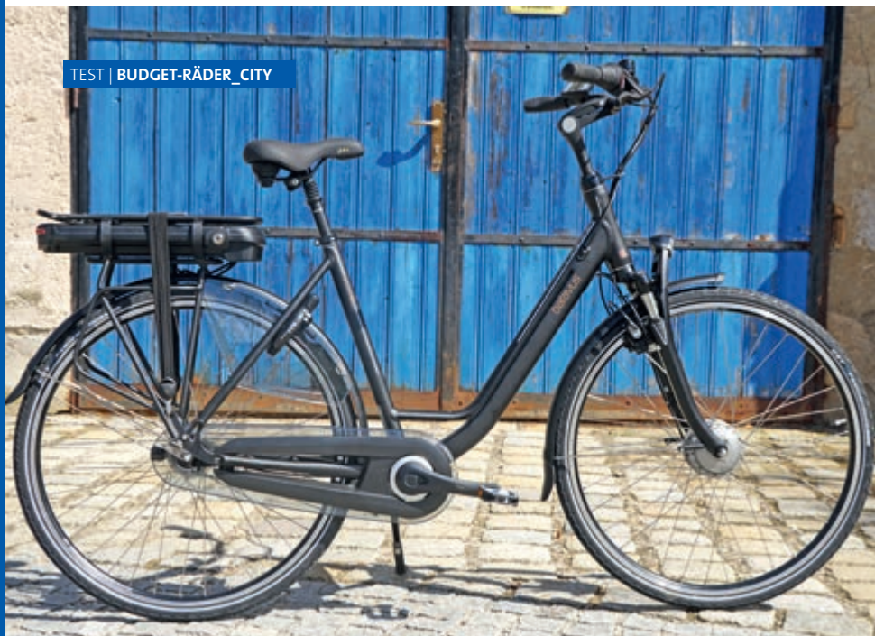
Kultivierter Frontmotor, an Anstiegen mittelstark, hier aktives Mittreten hilfreich.
