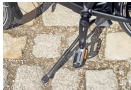
Rückwärtsschieben: Bei anschlagender Kurbel weicht der Ständer noch vorn aus.
