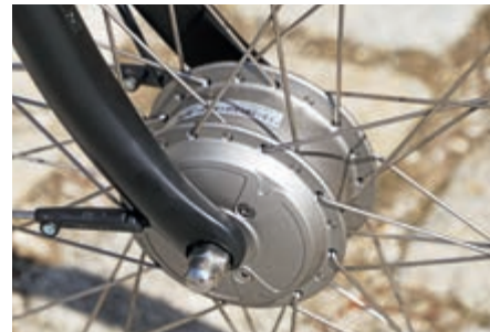
Kultivierter Frontmotor, an Anstiegen mittelstark, hier aktives Mittreten hilfreich.
